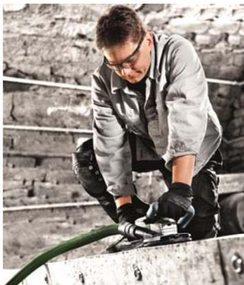
FESTOOL с подпружиненным щеточным фланцем и стеновым упором
