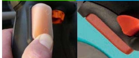
Collomix: защита выключателя в стандартной комплектации отсутствует
